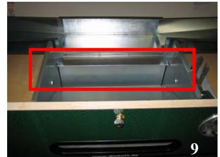
Die Führungsstange (Abb.7) in Richtung der Münzung (Abb.8) langsam herausziehen. Nun kann die Ballsperre (Abb.9) entnommen werden.
