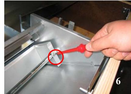
Die Feder (Abb.4) vorsichtig aushaken und anschließend die Schrauben der Schellen (Abb.5/6) entfernen.
