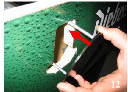
Mit einem passenden Gabel- oder Ringschlüssel (Schlüsselweite 10) die Muttern und Schellen (Abb.10) lösen. Die gelöste Münzung (Abb.11) kann nun aus dem Korpus gezogen und durch die Blindplatte (Abb. 12) ersetzt werden. Die Blindplatte kann nun durch die Öffnung (Abb.13) geschoben werden. Hierbei ist zu beachten dass je nach Bohrung die Blindplatte gedreht werden muss, sodass diese die Bohrung vollständig abdeckt.
